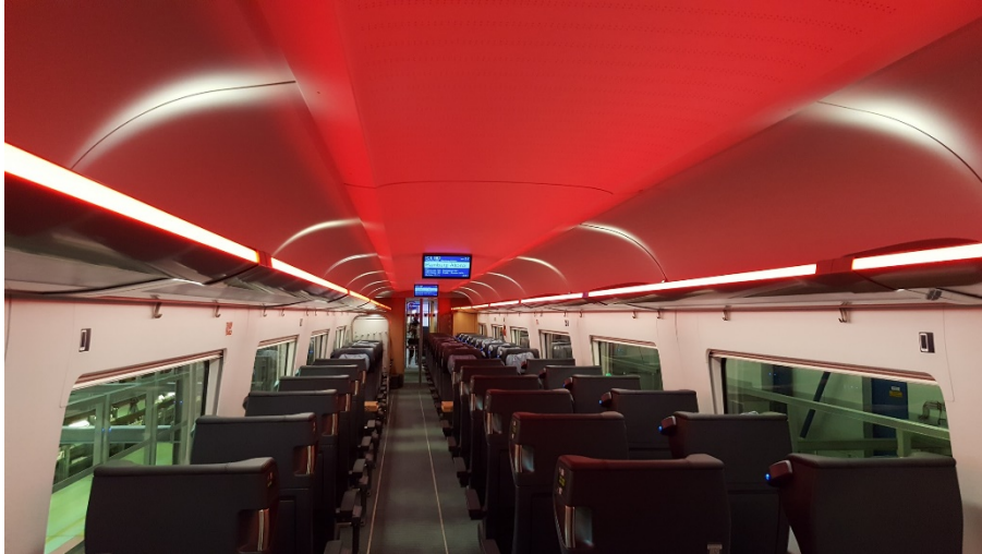
Abbildung 7 Tageszeitabhängige Beleuchtung im ICE 4. Bild André Dietenberger
