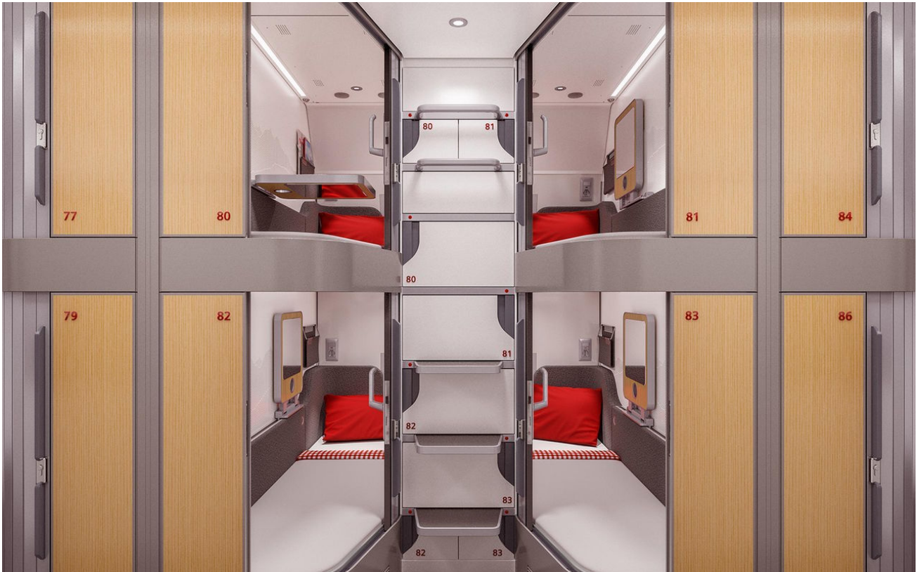
Abbildung 3 Abschließbare Einzelkabinen "MiniSuites" im Liegewagen des neuen NightJet Konzepts. Bild Siemens/ÖBB
