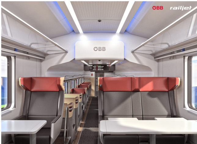
Abbildung 4 Sitze mit hohen und durchgängigen Lehnen im Großraum zur Geräuscherdrückung. Bild Siemens/ÖBB
